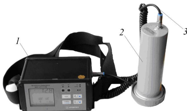
Рис. 14.3. – Дозиметр-радиометр МКС-АТ1117М: 1 – блок обработки информации (БОИ); 2 – блок детектирования БДПБ-01; 3 – соединительный кабель
