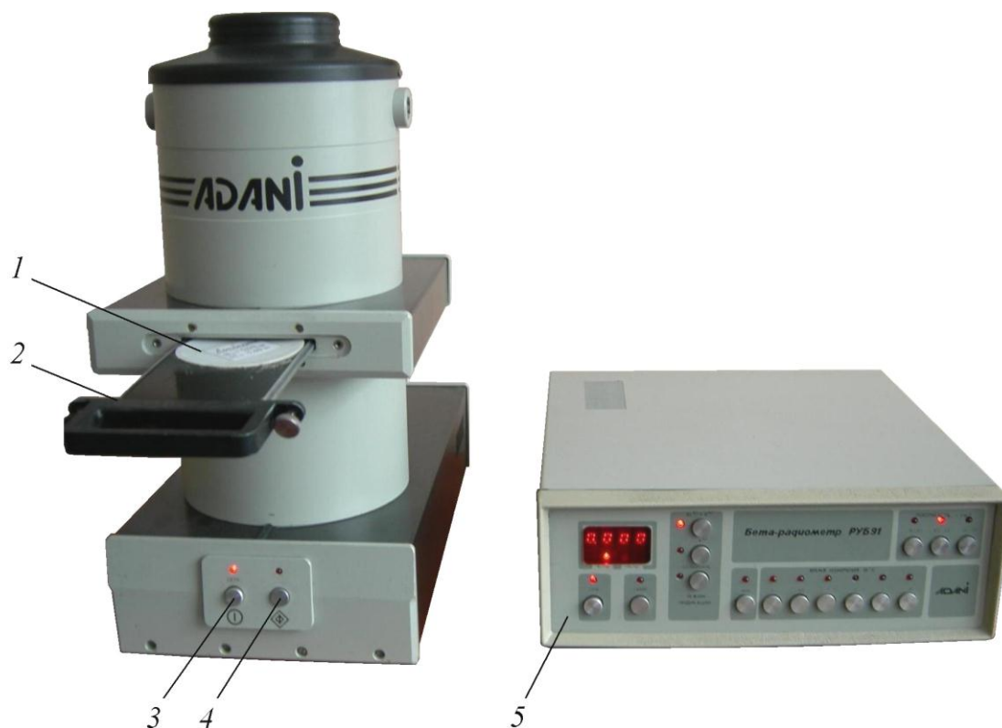
Рис. 9.1. Общий вид бета-радиометра РУБ-91 «АДАНИ»:
