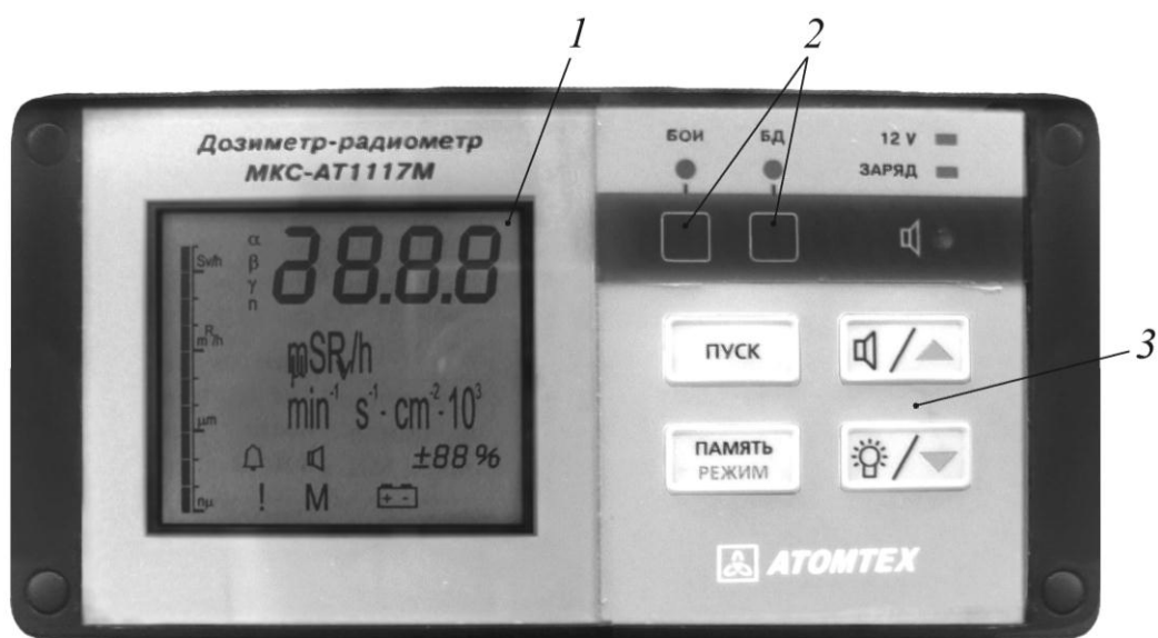
Рис. 4. Общий вид передней панели блока обработки информации: 1 – жидкокристаллический индикатор; 2 – индикаторы работы блока обработки информации; 3 – кнопки управления
